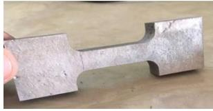
**Fig: 5.** Tensile Test Specimen
